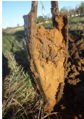
ARENA NETA, GRANULOMETRIA MEDIA Y GRUESA, DENSA Y MUY DENSA
