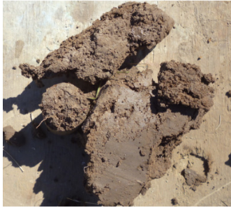
ARCILLA DE COLOR MARRON CLARO, PLASTICA. HUMEDAD BAJA, COMPACTA
