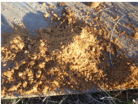
ARENA NETA, GRANULOMETRIA MEDIA Y GRUESA, DENSA Y MUY DENSA
