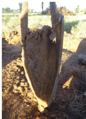
ARENA NETA, GRANULOMETRIA MEDIA Y GRUESA, DENSA Y MUY DENSA
